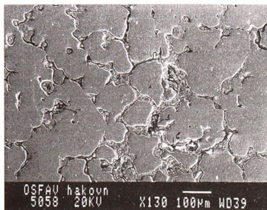
Obr. 6 a 7. Struktura materiálu fragmentu hákovnice I.č. 97 022. STEM.
