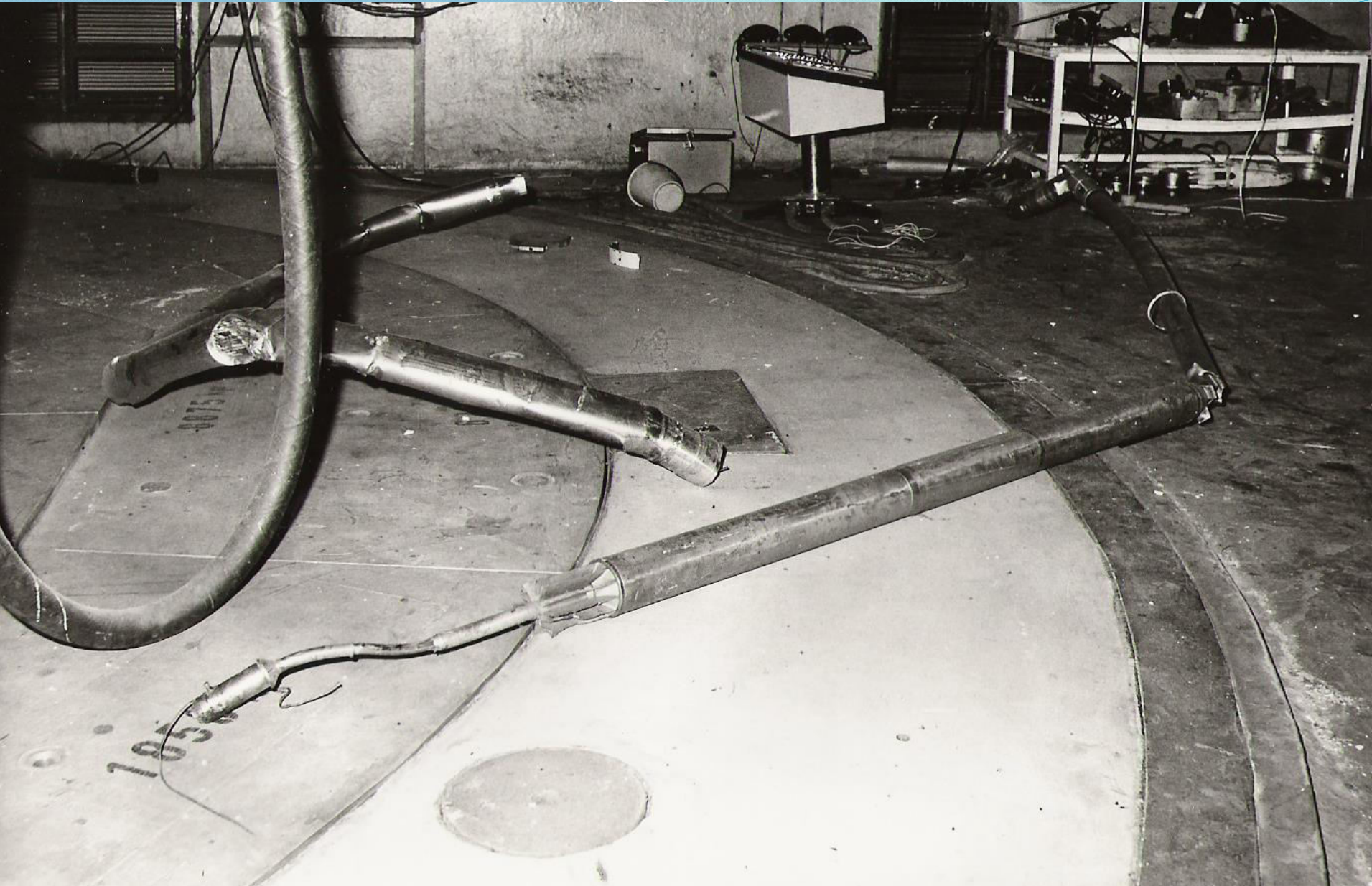
Vystrelený palivový článok z kanála H-05 na podlahe reaktorovej sály
