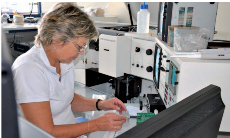
Odborná asistentka RNDr. Jarmila Číhalíková při obsluze průtokového cytometru používaného pro izolaci chromozomů pšenice
