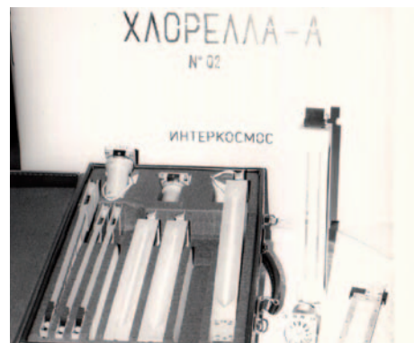
Kultivační zařízení „Chlorella - A“ určené pro testování růstu řas v beztížném stavu
