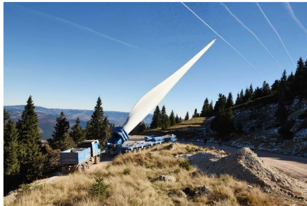
Příklad technologie blade lifter. Zdroj : www.felbermayr.cc
