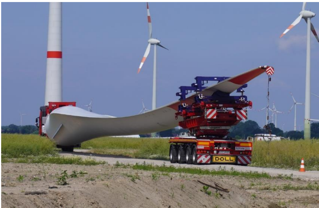
Transport listu větrné elektrárny
