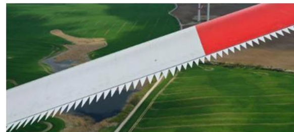
Serrations - rozbíjí turbulence na závětrné straně listu => snížení hlučnosti cca o 1 - 3 dB
